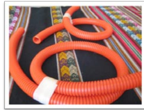
Caños corrugados enrollados a modo de trompeta
