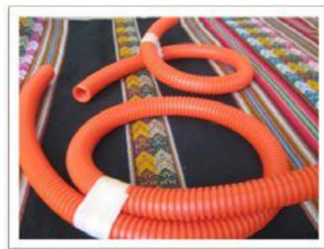
Caños corrugados enrollados a modo de trompeta
