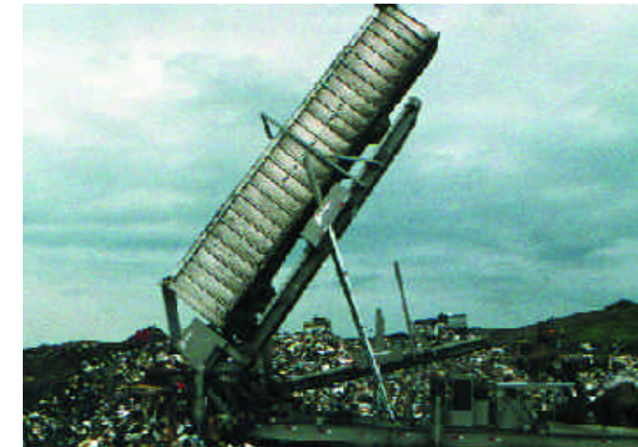
Figura 8.5. Sistemas de rampas de descarga móviles operadas hidráulicamente.
