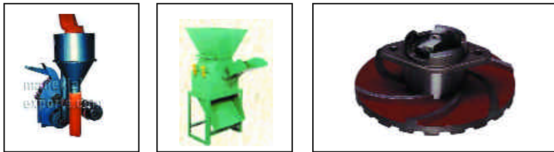
Figura 9.1. Tipos de trituradoras más utilizadas a) molino de martillo. Maneklal Global Exports; b) molino batiente. Maqtron, 2002; y c) trituradora cortante. VDGGroup, 2001
