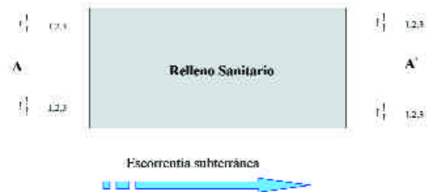
Figura 17.1. Esquema de flujo de aguas subterráneas y puntos de monitoreo: Plano. Fuente: Elaboración propia, 2002
