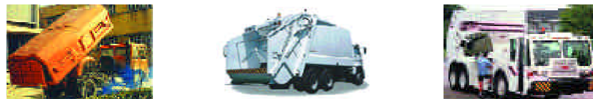
Figura 8.3. Sistemas de transporte tipo caja móvil: a) camión eleva contenedor; b) camión caja fija y; c) camión remolque.
