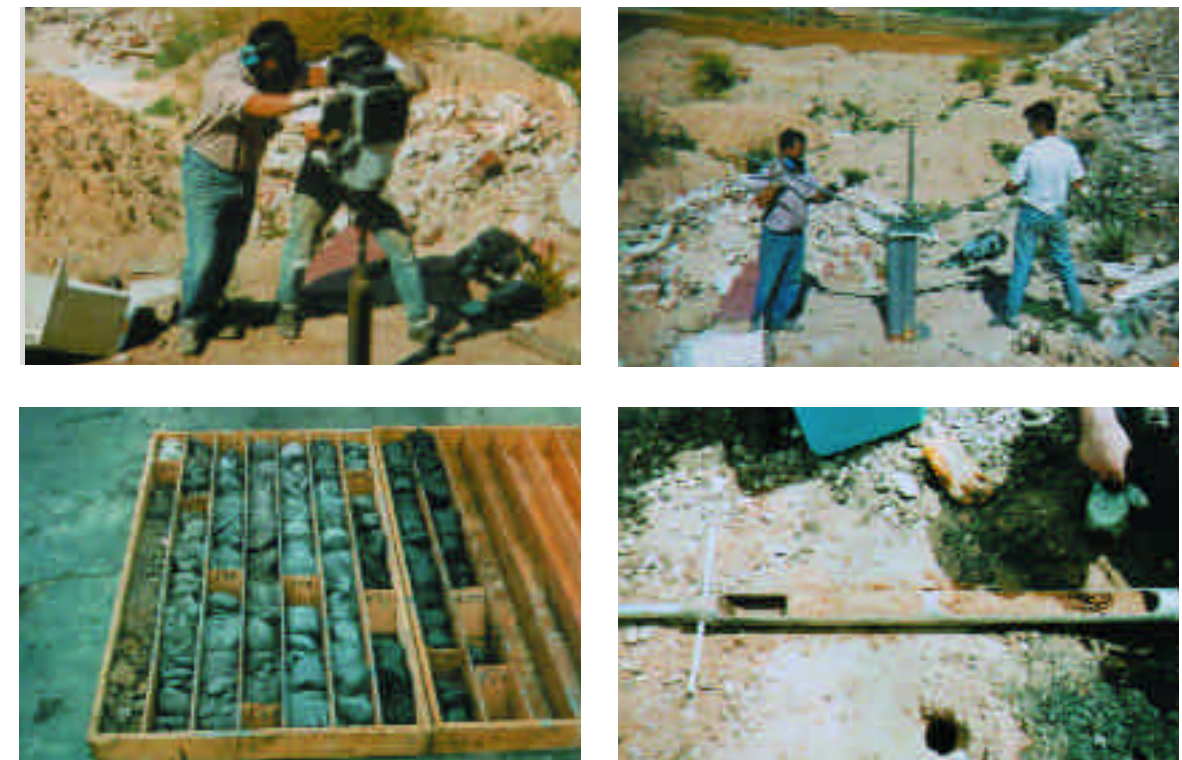
Figura 16.1.: a) Perforación del suelo con motor percutor; b) Extracción de la barrena mediante palancas; c) Testigo de un punto de muestreo; d) Detalle de la muestra extraída con la barrena.
